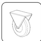
**Ролик Ø40 мм**
