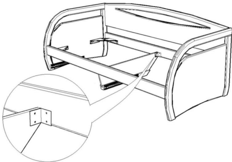
**Шаг 3** — Собрать ящик с помощью евроинтов, прибить дно гвоздями (расстояние между гвоздями ~ 10 см) и прикрутить полозья направляющих с помощью саморезов 3,5×16 мм согласно размерам указанным на схеме. Затем прикрутить ролики по краям ящиков спереди и снизу саморезами 3,5×16 мм.
