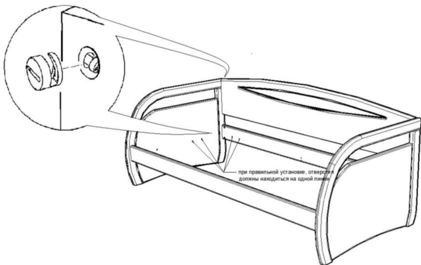
**Шаг 3** — Установить кронштейны с помощью винтов 6×16 мм (4 винта на каждый).
