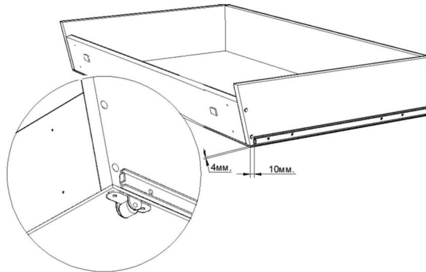
**Шаг 4** — Установить фасады с равномерным зазором на двухсторонний скотч и убедившись, что они установлены правильно, прикрутить их саморезами 4×30 мм, через отверстия на внутренней стороне ящика.
