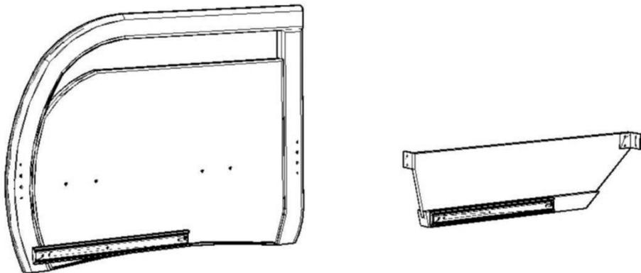
**Шаг 2** — Установить поперечную перегородку, закрепив её саморезами 3,5×16 мм (белыми) через уголки 50×50 мм к отверстиям, имеющимся в царгах.
